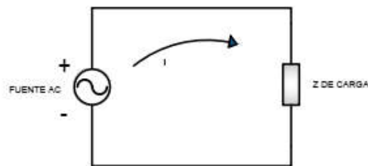
FIGURA 2-CIRCUITO MONOFÁSICO
