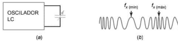
Figura 23.48 (a) La capacidad variable cambia la frecuencia de resonancia del oscilador LC. (b) La onda sinusoidal se ha modulado en frecuencia.
