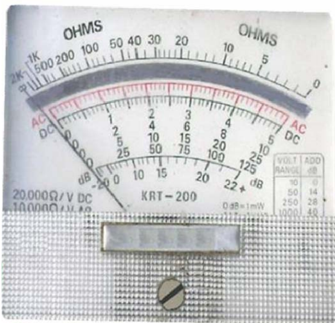
Puesta a cero en un multímetro análogo
